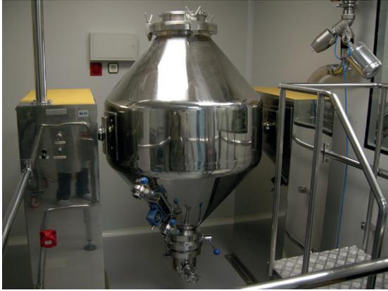
Misturadora bicónica com sistema de carga e descarga automático
